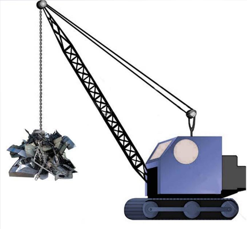
يمكن استخدام المغناطيس الكهربائي الكبير في الرافعة لنقل الخردة. لتحرير الحمولة، على السائق قطع التيار عن ملفات المغناطيس الكهربائي.
